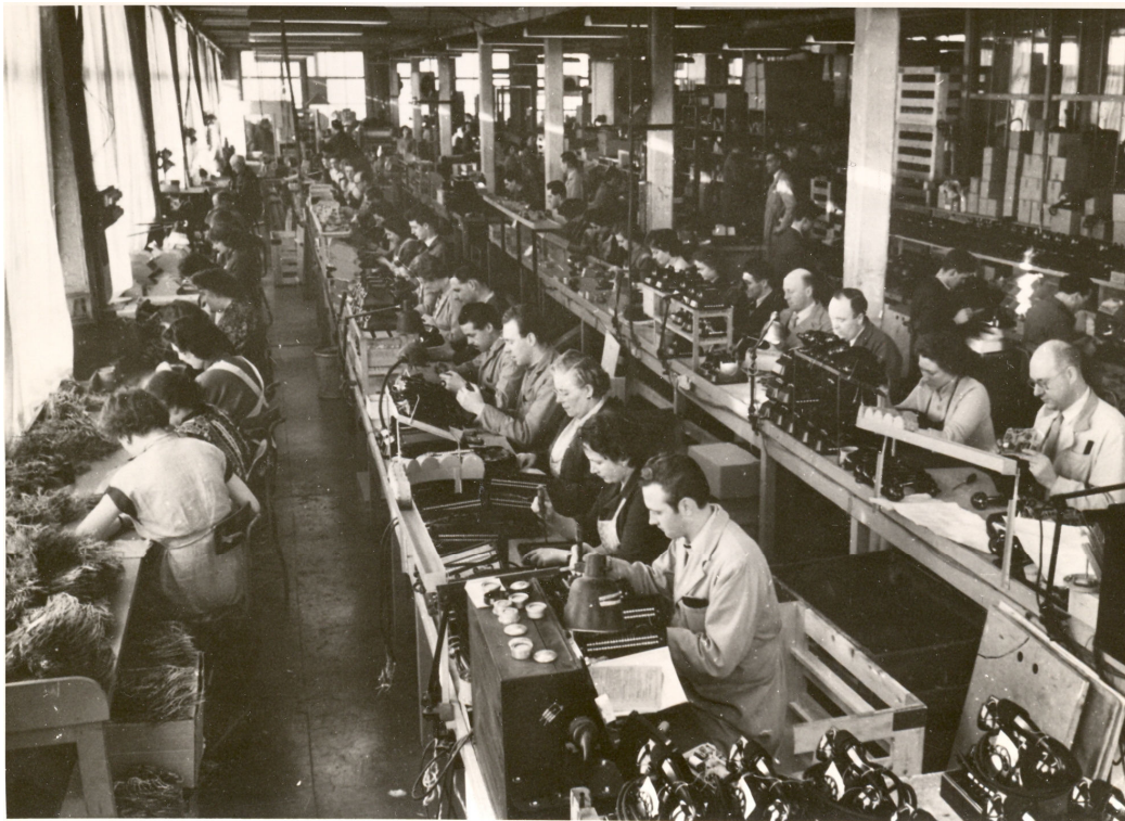
Figuur 12: Eindmontage van telefoontoestellen
