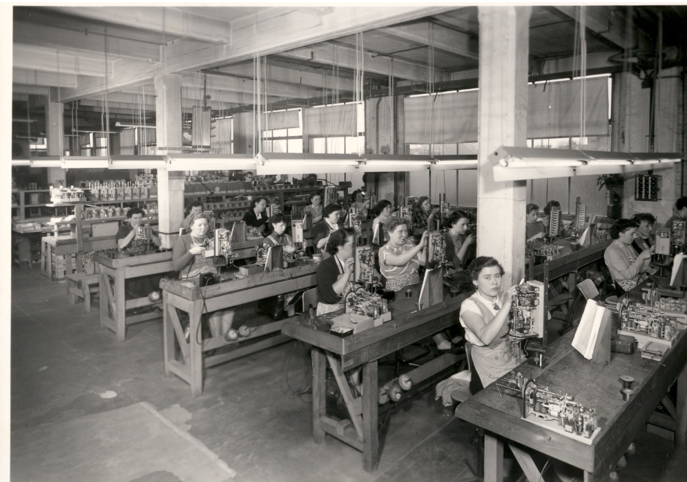
Figuur 9: Montage gesofistikeerde Hef & Draai schakelaars voor telefooncentrales
