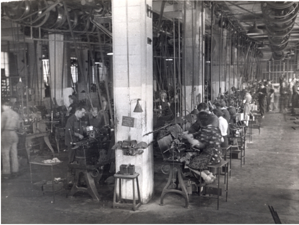
Figuur 7: DRAAIERIJ, draaibanken aangedreven via een bovenhangende as met één gemeenschappelijke motor.
