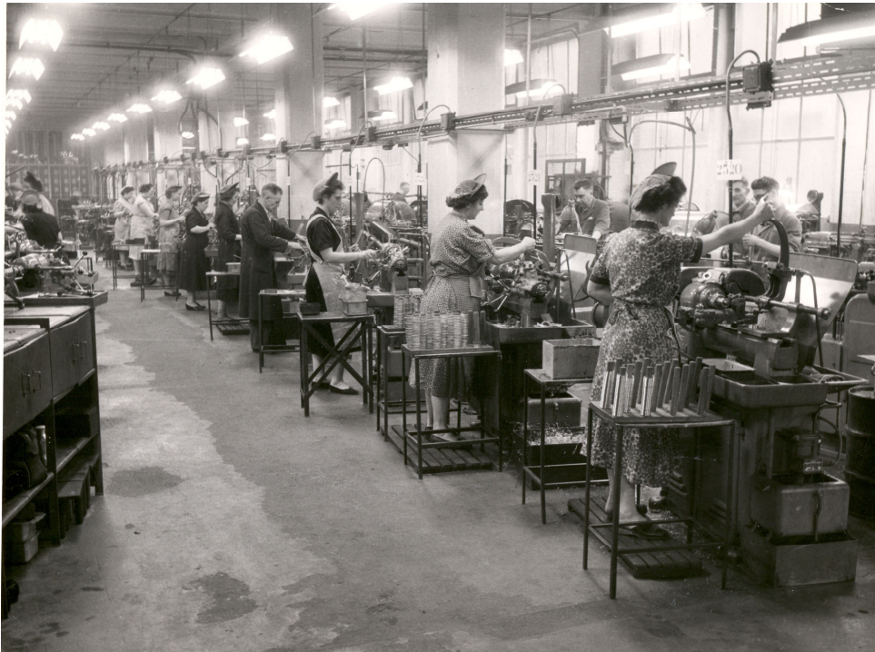
Figuur 13: DRAAIERIJ individueel aangedreven draaibanken, een stap vooruit ivgl met de bovenhangende aandrijving.
