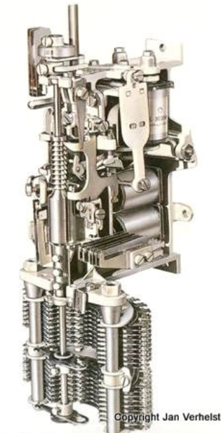
illustratie 6: de hef- en draaischakelaar, kern van het Strowger systeem
