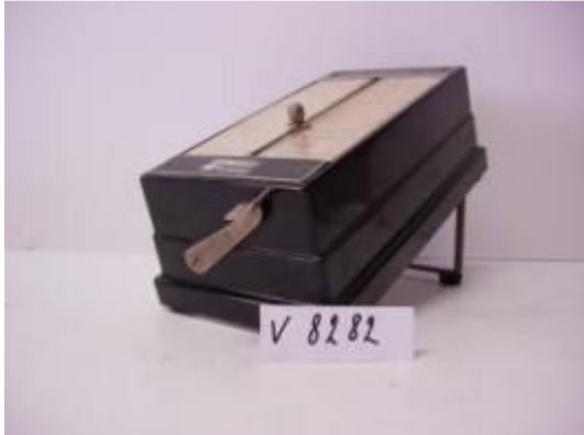
Figuur 11: Automatische nummervormer van Telerapid
